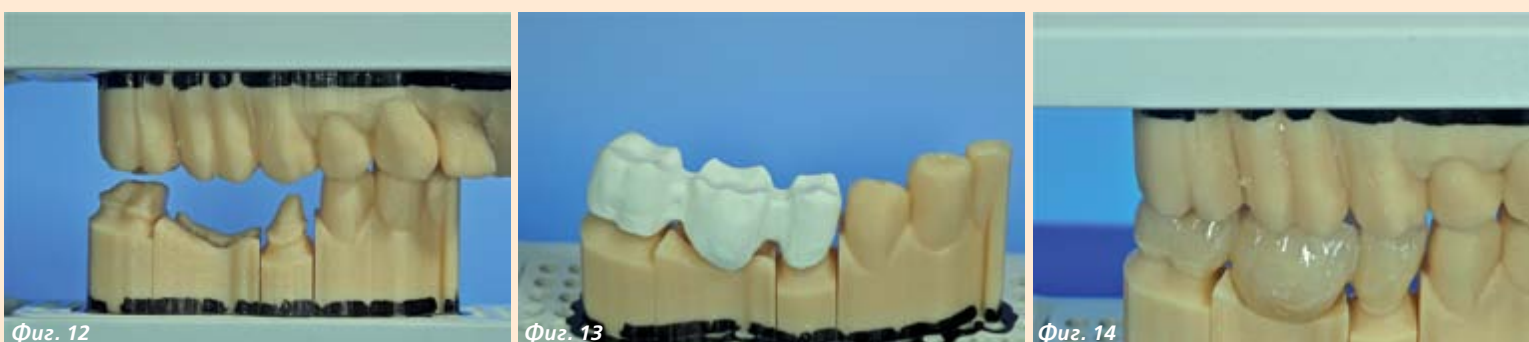
Фиг. 12 Стереолитографски модел (акрилен) за проба на скелета; Фиг. 13 Проба на скелета от ZrO 2 ; Фиг. 14 Облицоване и наартикулиране. (Фигури 11–14 са любезно предоставени от Балтзер.)
