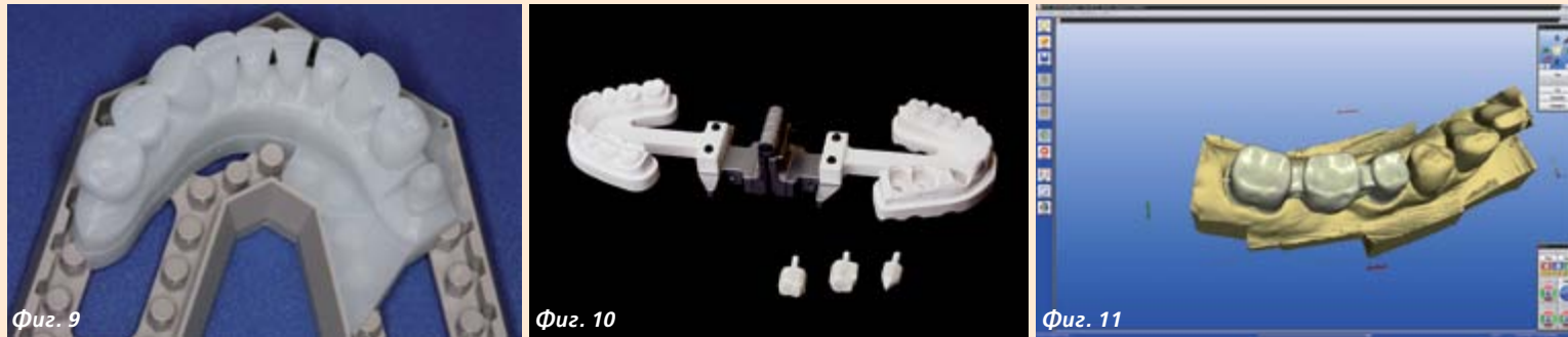
Фиг. 9 Стереолитографски изработен пластмасов модел с помощта на системата C.O.S. Lava. (Снимката е любезно предоставена от 3M ESPE.); Фиг. 10 Дигитално фрезован пластмасов модел с помощта на системата iTero; Фиг. 11 Конструиране на НК.
