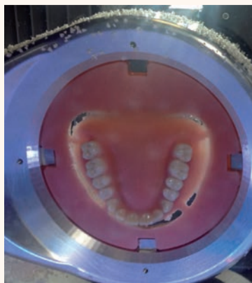
Фиг. 10 80 Load по време на фрезоващия процес.
