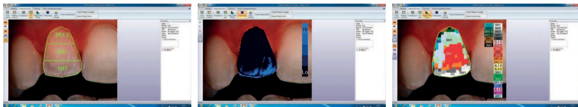
Figg. 1a-1c - Visualizzazione del colore tramite spettrofotometro Spectro Shade Micro (MHT): rilevazione di colore, traslucenza e mappe delle masse.
