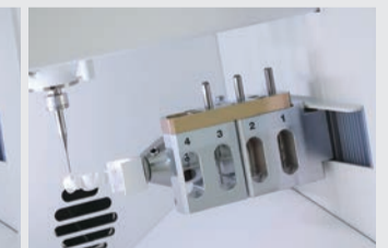
Cambio automatico a 4 posizioni.*
