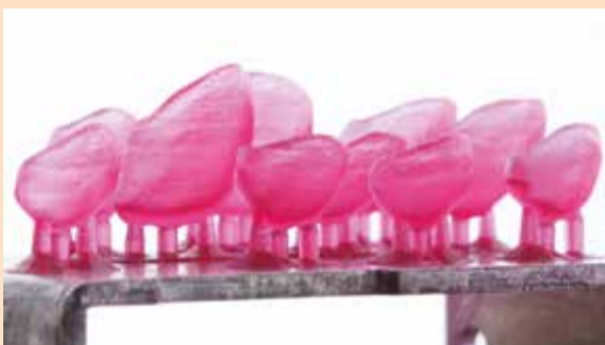
Slika 5: Isprintane ljske od sintetske smole.
