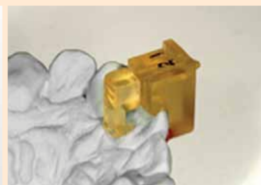
Фиг. 8В Джигър, използван за позициониране на брекета върху гипсов модел.
