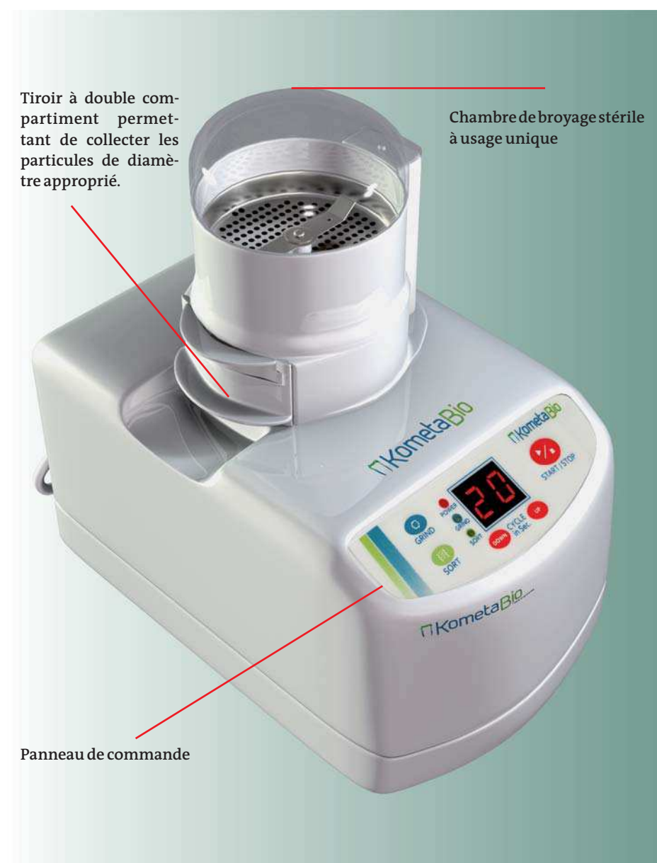
Smart Dentin Grinder: Système de broyage des dents et de tri des particules de dentine. Les particules de 300 à 1200 µm sont prélevées dans le tiroir puis décontaminées avant d'être réimplantées dans l'alvéole pour une greffe autologue.
