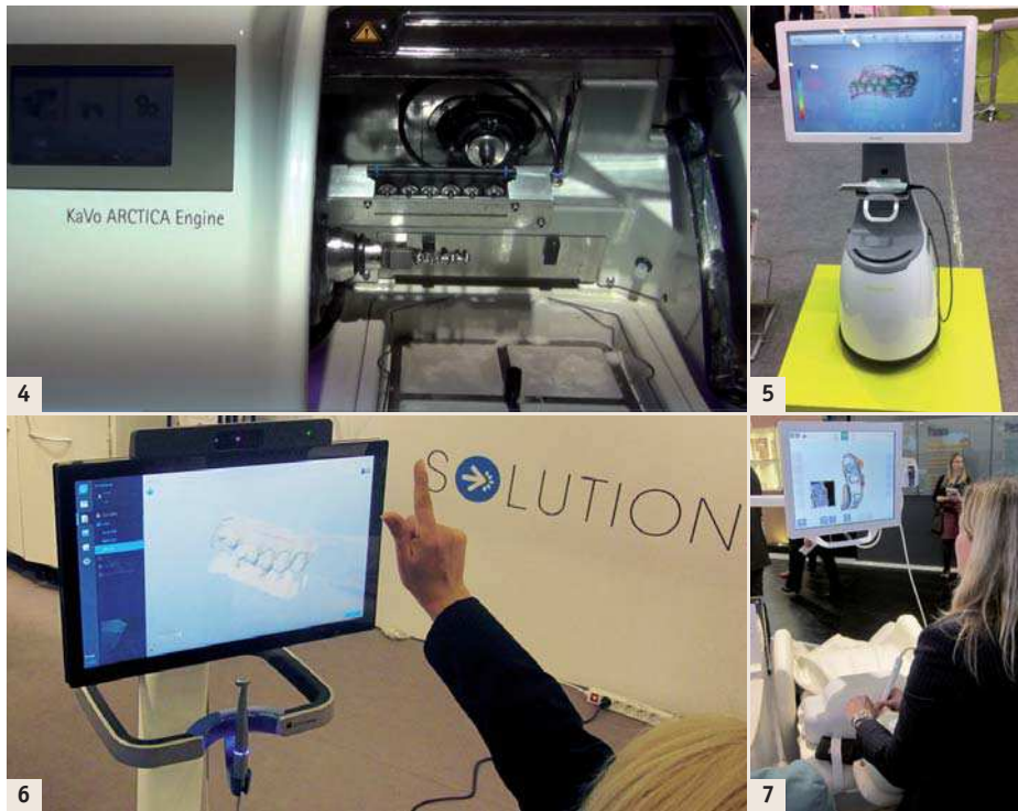
Fig. 4 : Usineuse ARTICA de KaVo. | Fig. 5 : Scanner intra-oral rainbow™ iOS de Dentium. Acquisition numérique sans poudrage et en monochrome. | Fig. 6 : Technologie « kinnect » sur système d'empreinte numérique Dental Wings : reconnaissance de signes manuels sans contact. | Fig. 7 : Scanner intra-oral de GC et son écran tactile.
