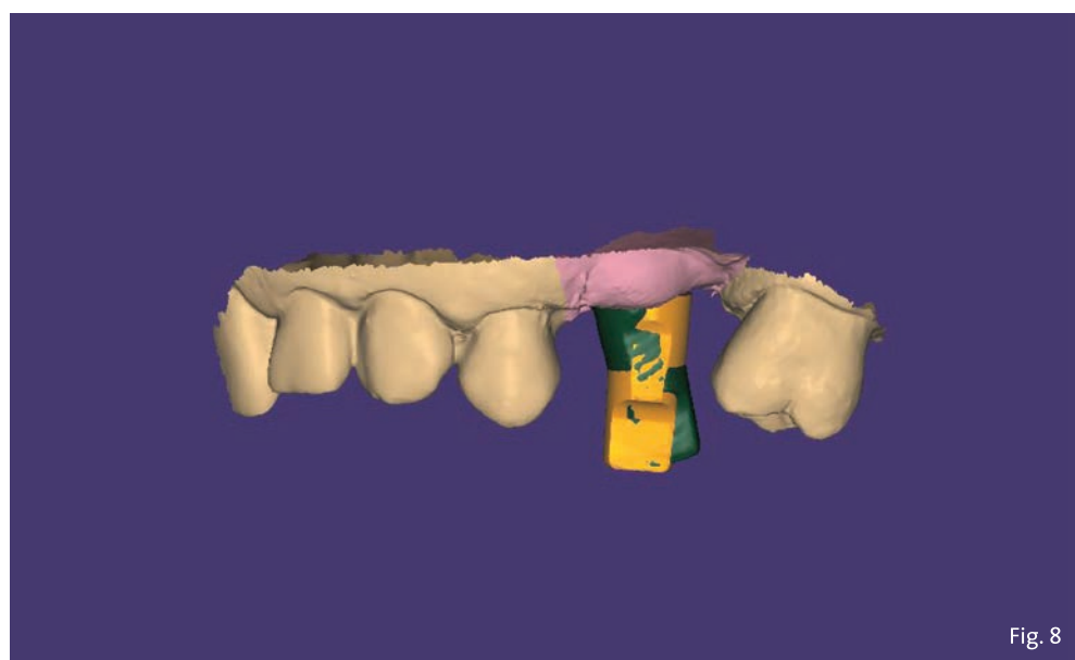
Fig. 8 - Matching tra marker scansionato in verde e libreria protesica vettoriale in giallo.
