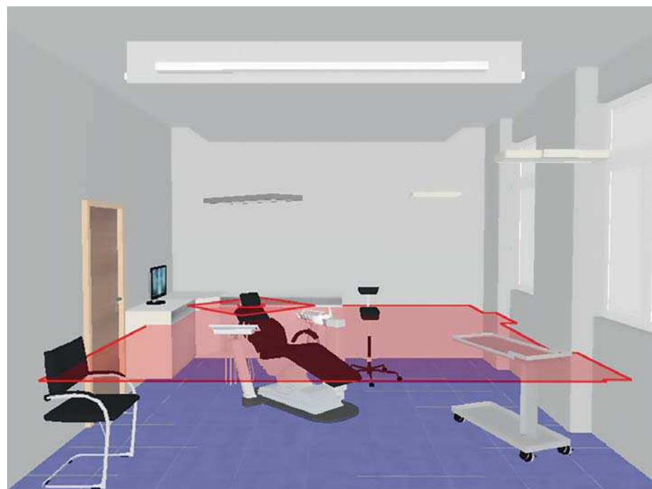
Principe de calcul des zones à éclairer
