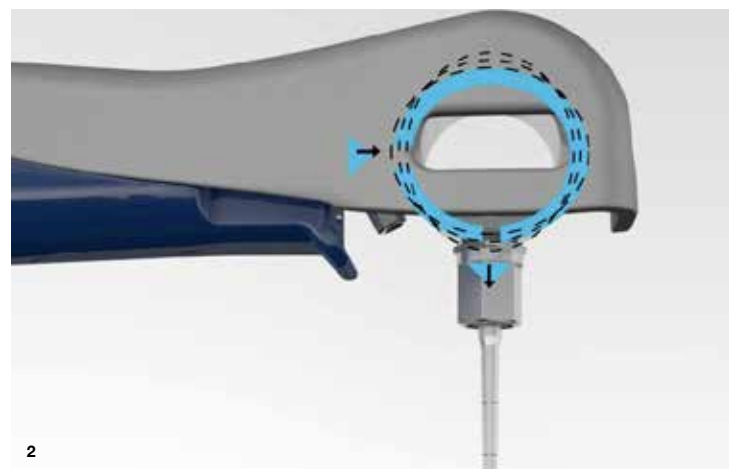
Slika 2: Vector Paro princip: vertikalno oscilirajoč nastavek kot rezultat prenosa ultrazvočne frekvence preko prstana.
