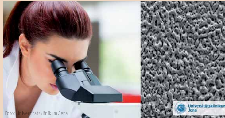
Elektronenmikroskopische Aufnahme der porösen, bioaktiven Titanoxidoberfläche.
