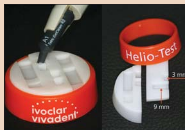
Рис. 1. Устройство Heliotest компании Ivoclar Vivadent; заполняется композитными материалами и разбирается на части.
