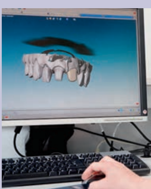
Ontwerpen van twee onderstructuren voor opgebakken zirkoniumoxide-kronen.
