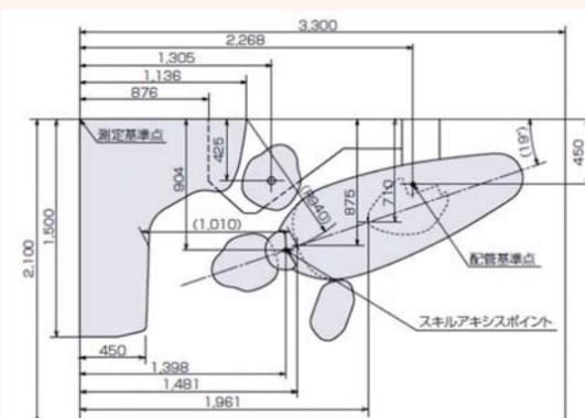
Fig. 7 : Dimensions du meuble, et positionnement de l'unit.
