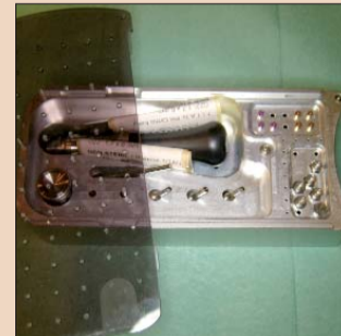
Obr. 2.8 a – b: Předvrtání 4 mm dlouhým ostrím a zarážka: Drill (FORESTADENT) a tomas-drill SD DENTAURUM.
