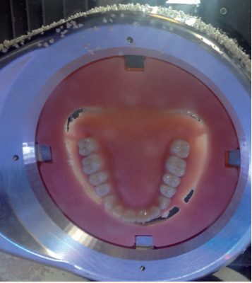
Фиг. 10 BD Load по време на фрезова- щия процес.
