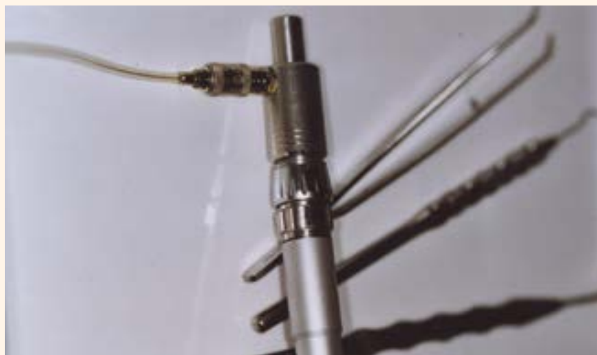
Figura 2. Para cada conexión de la turbina (también para la conexión de aire en laboratorios dentales), hay un acoplamiento de adaptador de montaje.
