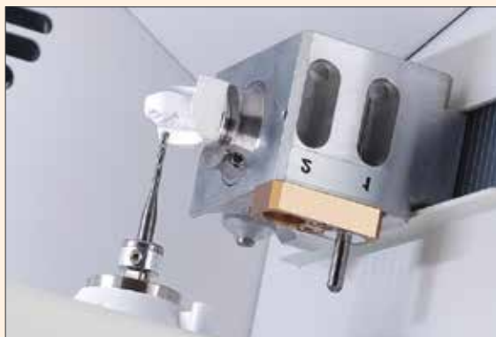
Fresado en seco de restauraciones dentales.
