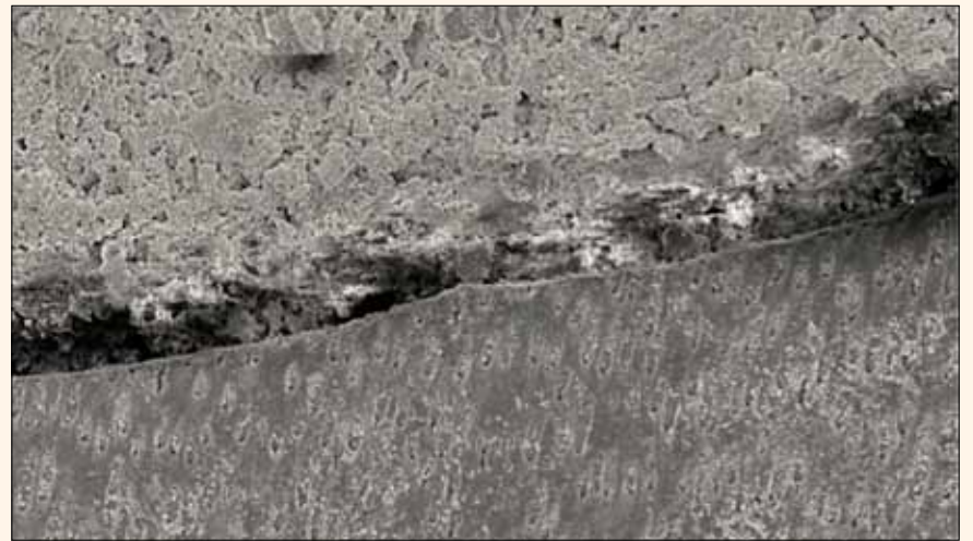
Figura 1: Interfase de desadaptación a dentina de un cemento de hidróxido de calcio fraguado, producida por su contracción de solidificado. Obsérvese el hiatos material-dentina y la falta de sellado de los túbulos dentinarios. FEG SEM x1.250
