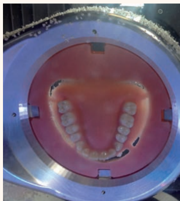
Фиг. 10 80 Load по време на фрезоващия процес.
