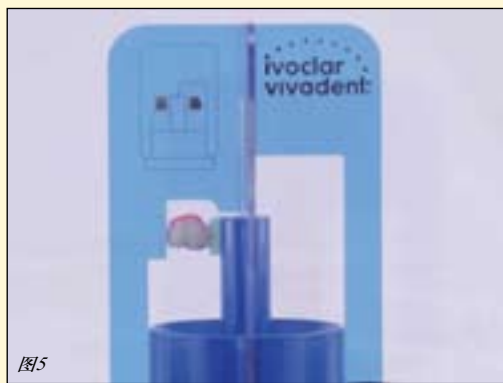
图4: 安装好铸道的修复体蜡型与铸圈底座相连。图5: 模版 (IPS e.max Press Multi铸道导轨) 用以确认蜡型在铸圈中的位置。图6: 安装好的铸圈底座。
