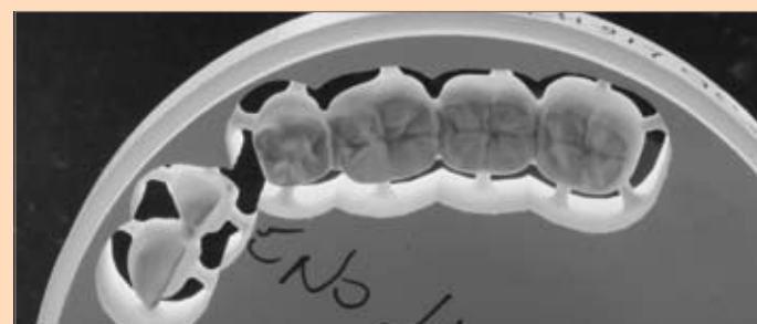
Sl. 11. Nadoknade nakon frezovanja obojenog Zenostar T1 cirkonijum materijala (Wieland Dental).
