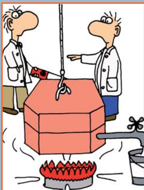
Durch Erhitzen fließt das Wachs aus dem Gipsblock.
