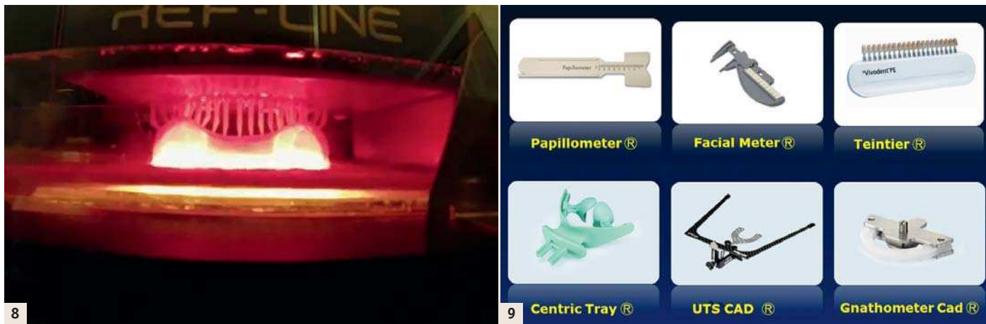
Fig. 8 : Impression 3D d'une base définitive en résine (Image REF-LINE). | Fig. 9 : Instruments pour prothèse complète assistée par CFAO.
