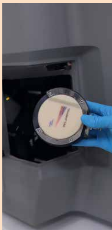
Sl. 7: Blok SR Vivodent CAD Multi montira se sa oznakom prema gore
