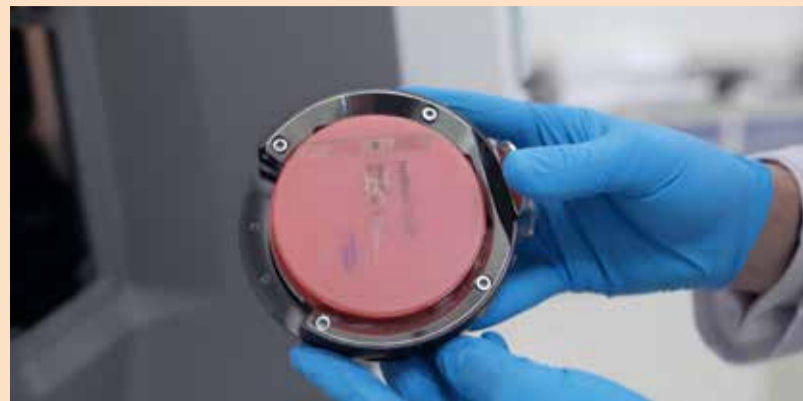
Slika 8. Blok Ivobase CAD za izradu baze proteze
