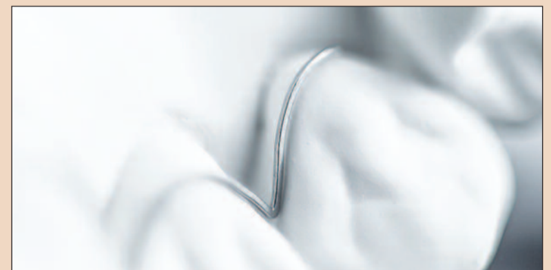
Рис. 14. Увеличенное изображение ретейнера Memotain после электрохимической полировки. Края проволоки, сохраняющей квадратное сечение, закруглены.
