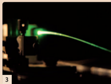
Abb. 3: Biosilica-Glasnadeln aus Schwämmen sind lichtleitend (hier: Pfahlnadel des Tiefsee-Glasschwamms Monorhaphis chuni). – Abb. 4: Gute Bindeeigenschaften des auf Biosilica basierenden osteoinduktiven Kompositmaterials (Autofluoreszenz).
