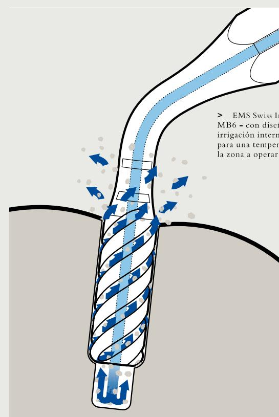
> EMS Swiss Instrument Surgery MB6 – con diseño espiral único y irrigación interna del instrumento para una temperatura ultrabajada en la zona a operar
