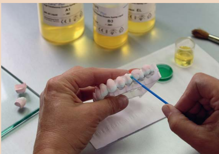
Anwendung der Lava Plus Färbeflüssigkeiten von 3M an einer monolithischen Versorgung aus Lava Plus Zirkoniumoxid. (Foto: 3M)
