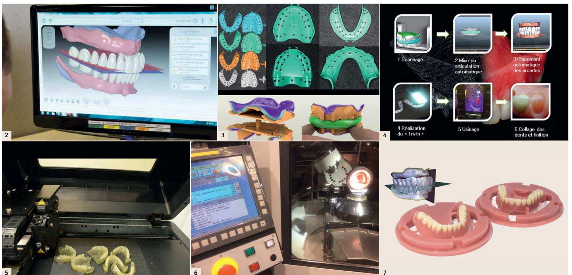
Fig. 2 : CAO en centre de production de prothèse complète (Image AvaDent). | Fig. 3 : Pour réalisation de la prothèse complète bimaxillaire : principe d'enregistrement de la dimension verticale et de la relation centrée, par porte-empreinte sectionné réglable (Image DENTCA). | Fig. 4 : Phases laboratoire réalisées en centre de production. | Fig. 5 : « Try In » en impression 3D (Image DENTCA). | Fig. 6 : Usinage de disques de résine PMMA (Merz Dental) présenté à l'IDS 2015. | Fig. 7 : Disques PMMA de la société Baltic Denture System (Merz).
