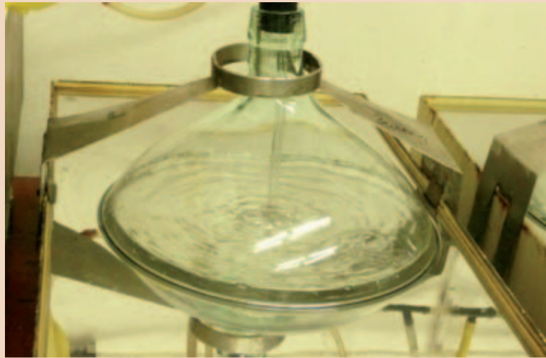
Destillierglocke und Behandlungsbecken bei der GMR.
