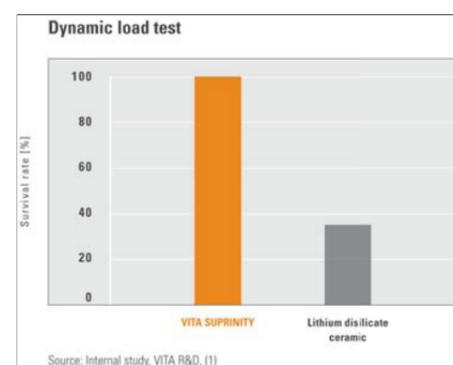
\* Рис. 3: При длительном испытании на устойчивость к динамическим нагрузкам (1 200 Н) и 1,2 млн. циклов (= примерно соответствует 5-летнему сроку эксплуатации в полости рта) процент выживаемости коронок из VITA SUPRINITY составил 100%. Источник: внутреннее исследование, VITA F&E
