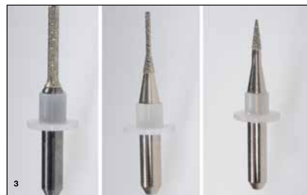
Slika 3: V enoti EASY Mill4 se uporabljajo tri različne diamantne konice s premeri 2 mm, 1 mm in 0,6 mm.
