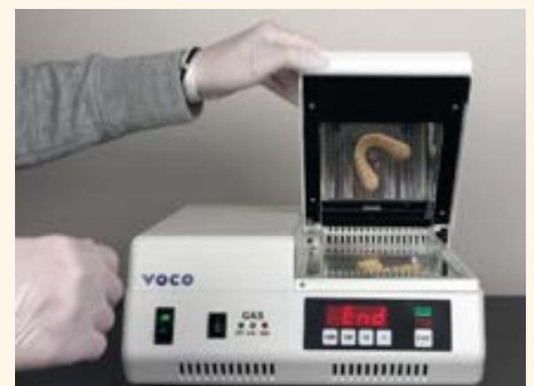
Figura 13. Unidad de fotopolimerización por luz ultravioleta.
