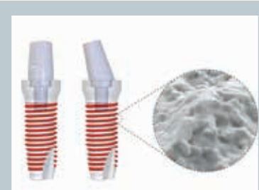
Afb. 6: Schematische weergave van tweedelige implantaten met recht of schuin abutment, met weergave van de laser-opervlaktebehandeling van de schroefdraad.
