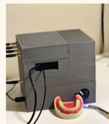
Устройство O-pH является источником синего света малой мощности; в сочетании со специальным красителем такое излучение вызывает флуоресценцию участков биопленки, характеризующихся повышенной кислотностью. (Фото: Manuja Sharma, Вашингтонский университет)
