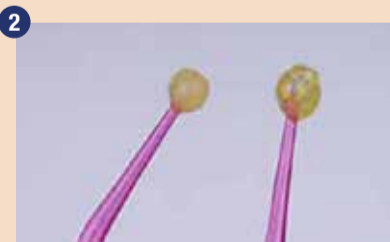
G2-BOND Universal: 1-PRIMER in 2-BOND. Njuna rumenkasta barva pomeni prisotnost fotoiniciatorja v obeh komponentah. Barva po polimerizacijski reakciji izgine.
