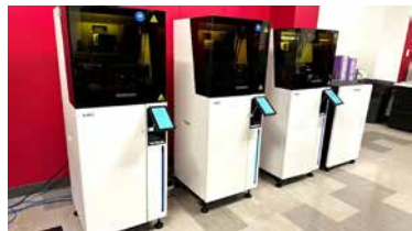
1. ábra: A NEOLab által használt UltraCraft A3D 3D nyomtatók és a gyantaállomás (HeyGears). (Minden kép: HeyGears).
