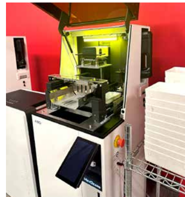
6. ábra: Automatizált kar a HeyGears UltraCraft A3D nyomtatón.
