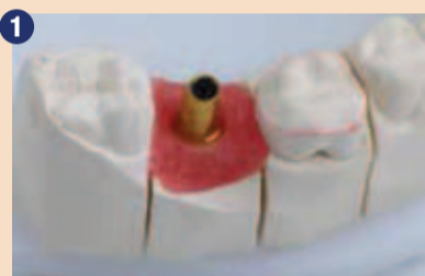
1 Delovni model z gingivalno masko in raven abutment - opornik.
