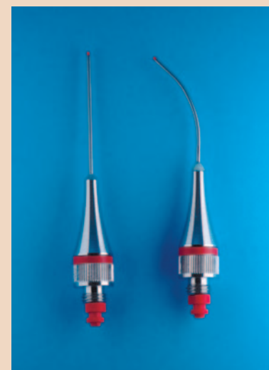
Рис. 10. После стерилизации игла приобретает исходную форму
