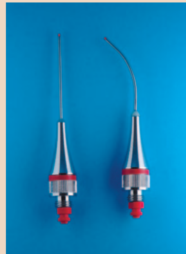
Рис. 10. После стерилизации игла приобретает исходную форму
