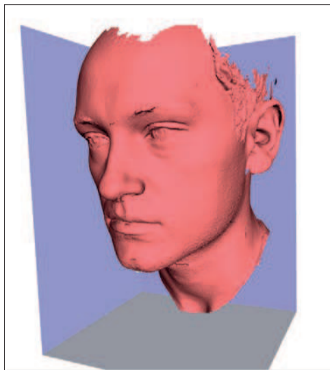
Fig. 1 - Sistema cartesiano di riferimento: sono evidenziati i piani di riferimento grazie ai quali verranno creati quelli di costruzione.
