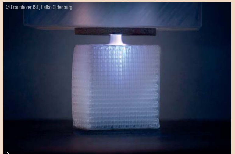
Abb. 2: Beschichtung von Gerüststrukturen für Implantate mit einem Plasma-Jet.
