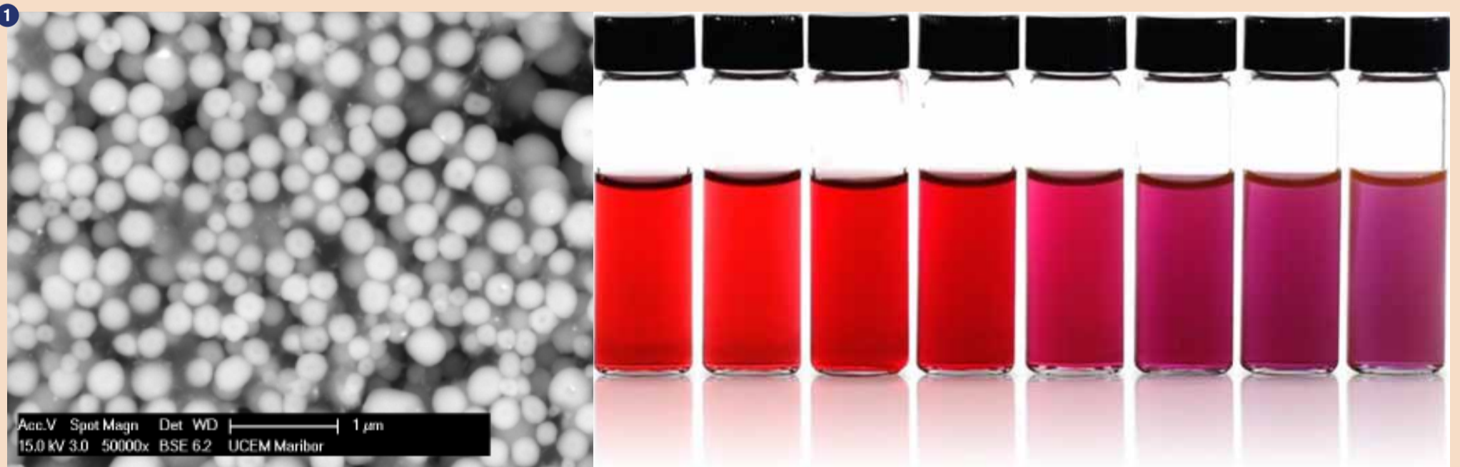
Slika 1: Zlati nanodelci, izdelani v Zlatarni Celje d.o.o. (Mikroskopnetek ter NAu v raztopini vode)
