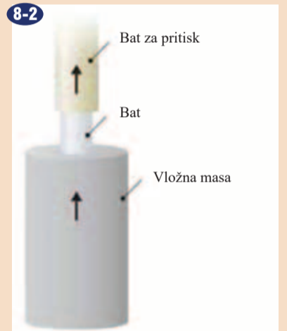
8-2 Ko je prešanje končano, bat za pritisk dvigne bat in povzroči srkanje že prešane keramike.
