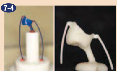
7-4 Dolžina odvoda pod primernimi pogoji tlačjenja. Odvod ob prešanju postaja krajši, če je keramika nezadovoljivo mehka, in nasprotno daljši, ko je premehkka. Parametri peči se morajo prilagoditi glede na pogoje prešanih odvodov.
