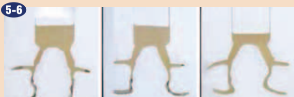
5-6 Prešanje v kalup v vložni masi.
