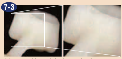
7-3 Mnogo naključnih lunkerjev kot krater.
