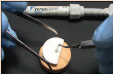
Рис. 7. Установка композитного столбика на поверхность цемента.
