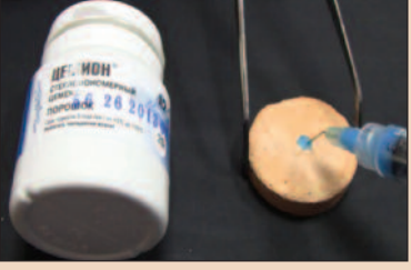
Рис. 4. Нанесение ортофосфорной кислоты на поверхность цемента.
