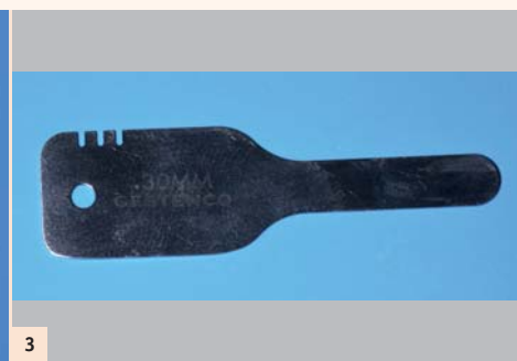
Fig. 3: L'utilisation de la jauge va permettre de mesurer avec exactitude le manque de céramique de la prothèse.
