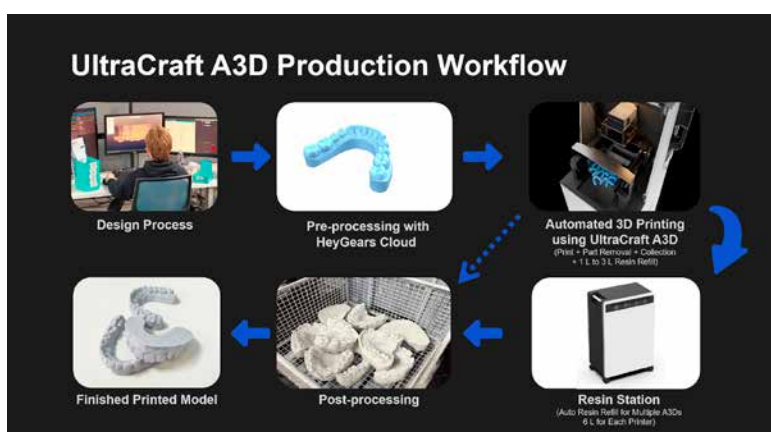
4. ábra: Az UltraCraft A3D nyomtató és a gyantaállomás teljes munkafolyamata.
